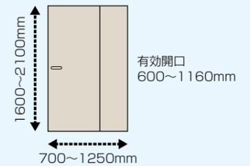
木製ドアタイプ 32~40mm トイレブースタイプ 40mm 木製ドアタイプ 20kg以下 (2枚の合計) ダンバーヒンジ仕様 30kg以下 (2枚の合計) トイレブースタイプ 20kg以下 (2枚の合計)
